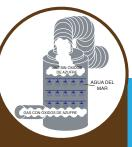
Los gases de combustión son rociados con agua de mar para reducir la concentración de óxidos de azufre. Posteriormente, se liberan a través de la chimenea.
